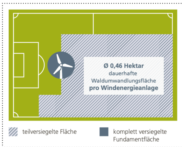
Abbildung 3: Dauerhafter Flächenbedarf einer Windenergieanlage im Wald. Eigene Darstellung; Quelle Waldumwandlungsfläche: FA Wind 2023
